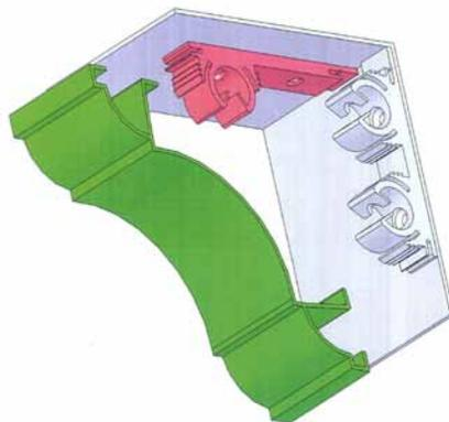
L'habillage vient finir l'installation en se **clipsant facilement** sur les supports sous forme de corniche ou de plinthe. **3** Un rendu très **esthétique**.
